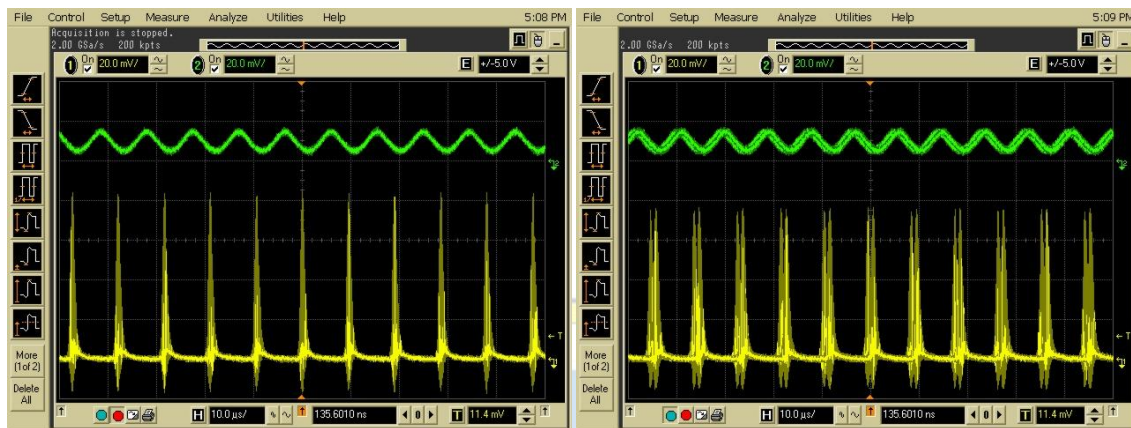
圖 4-14 (a) (b) 圖 4-14 (a) 為 105.4 kHz 時在示波器上的穩定 Q 開關鎖模圖形。(b) 111.6 kHz 時在示波器上的穩定 Q 開關鎖模圖形。
