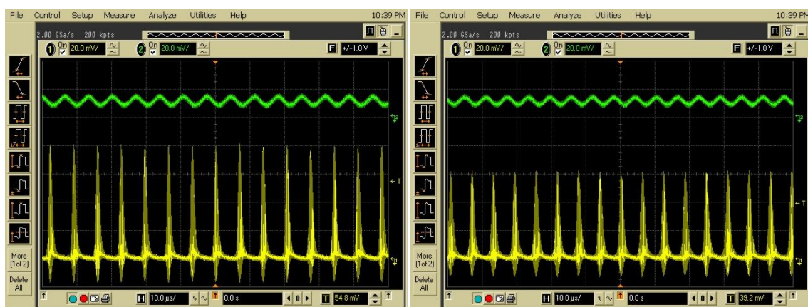
圖 3-15 (a) (b) 圖 3-15 為 (a) 為 105.4 kHz 時在示波器上的穩定 Q 開關鎖模圖形。(b) 為 131.8 kHz 時在示波器上的穩定 Q 開關鎖模圖形。
