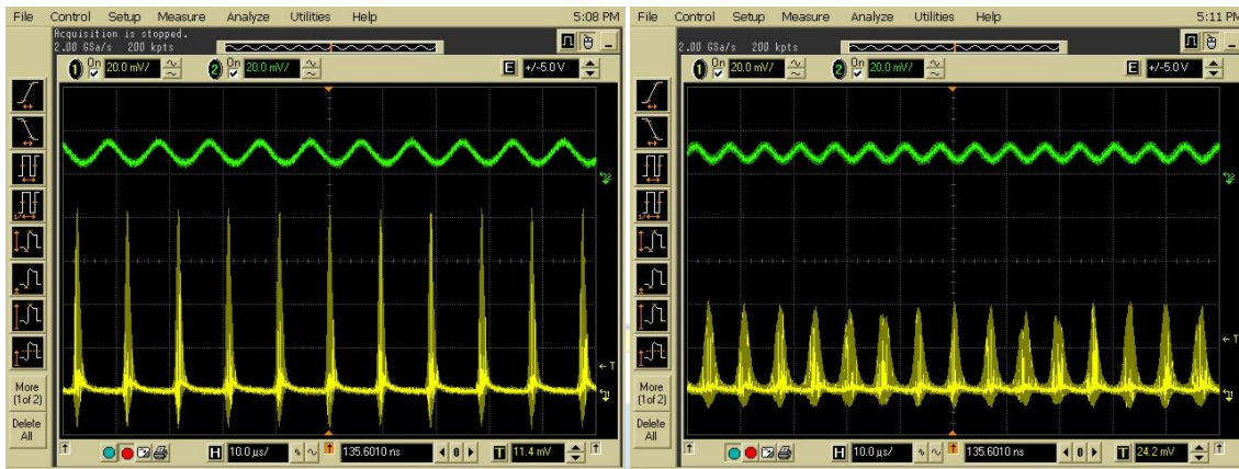
圖 4-16 (a) 調制頻率 105.4 kHz 時在示波器上的穩定 Q 開關鎖模圖形。(b) 調制頻率 152 kHz 時在示波器上的穩定 Q 開關鎖模圖形。
