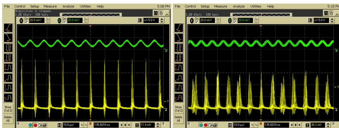
圖 4-15 (a) (b) 圖 4-15 為 (a) 為 105.4 kHz 時在示波器上的穩定 Q 開關鎖模圖形。(b) 為 131.8 kHz 時在示波器上的穩定 Q 開關鎖模圖形。
