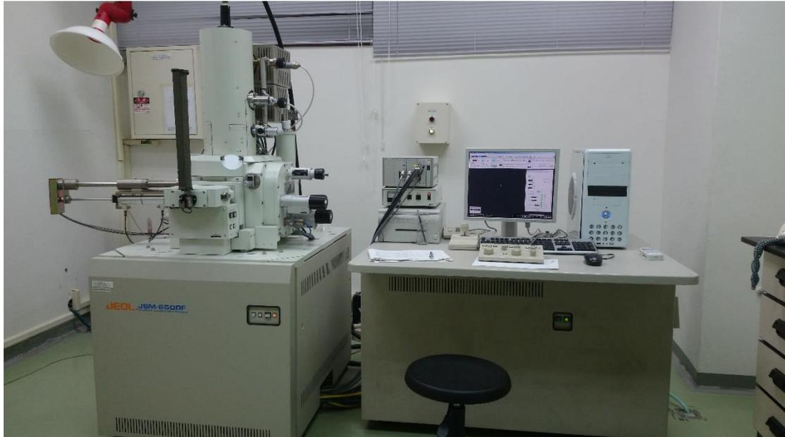
圖 3-5 JEOL JSM-6500F 熱場發掃描式電子顯微鏡
