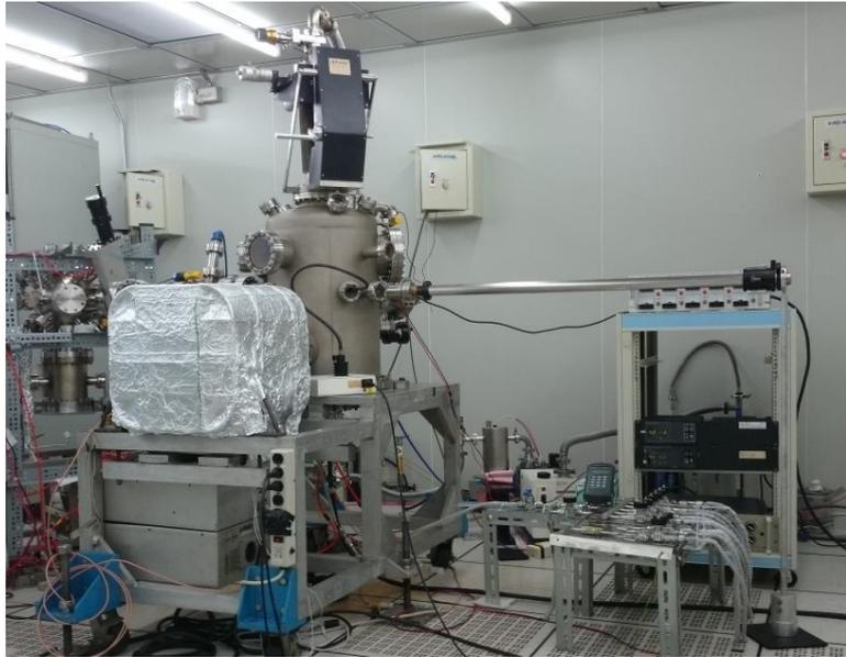
圖 3-3 電容式耦合射頻電漿化學氣相沉積系統
