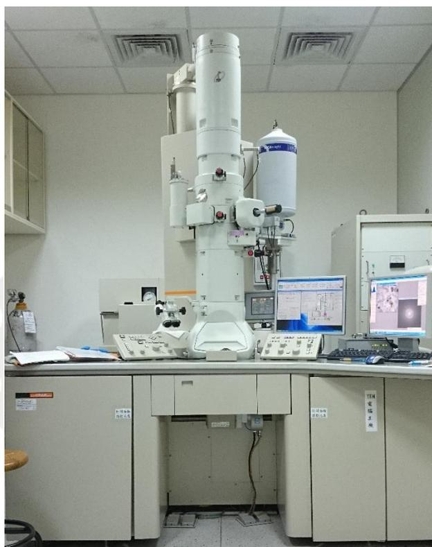
圖 3-6 JEOL JEM-2100 高解析度穿透式電子顯微鏡
