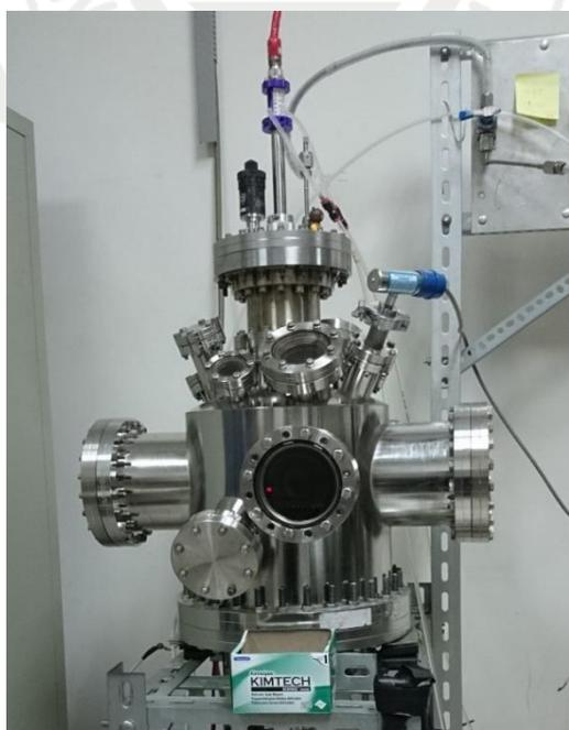
圖 3-2 射頻磁控濺鍍系統
