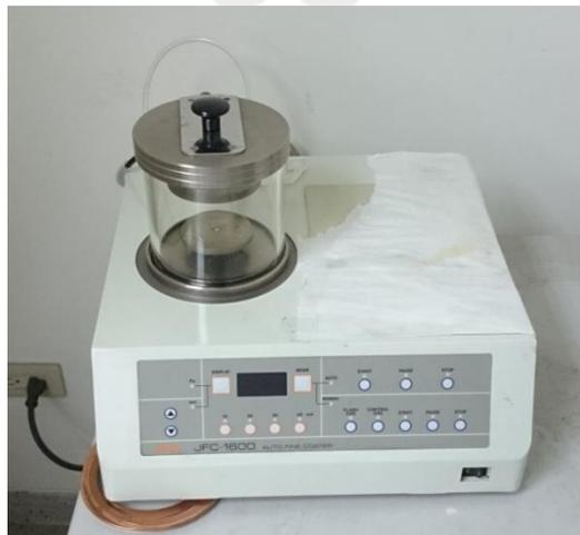
圖 3-1 直流磁控濺鍍系統 JEOL JFC-1600
