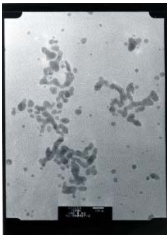
圖 4-1.6 放電加工銀的 TEM 圖
