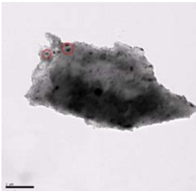
圖 4-3.2 樣品 Re 在 HRTEM 所觀查的情形,顯示微粒大小分布並不均勻
